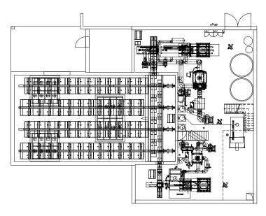
ser beiden vollautomatischen Biomassekessel eine Spitzenlast von 1.500 Kilowatt. In den Sommermonaten ist meist eine Leistung von 500 Kilowatt ausreichend." Die bereitgestellte Wärme der Hackgutanlage wird in zwei Puffern mit je 18.000 Liter Inhalt gespeichert.
