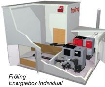
Stahlbeton-Containern. Ein Container beinhaltet die Kesseltechnik. Hier können flexibel bis zu zwei Kessel der Serie Fröling TX im Leistungsvermögen von 150 bzw. 250 kW Nenn-
